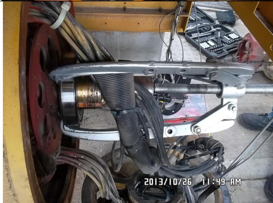
Procedimiento para extracción del rodamiento del alternador ppal.
