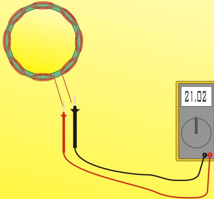
Desconectar las líneas del regulador de tensión y verificar su valor de resistencia en OHMIOS de de acuerdo al tipo de alternador se debe tener el valor de resistencia del campo fijo (excitatriz) líneas F+ y F-, E+ E- X XX de acuerdo al tipo de alternador.
