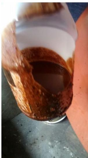
La combusti6n incompleta Perdida de potencia Holl6n C6mara de combusti6n carbonada Mayor consumo de combustible. Cuando el agua llega al fondo del tanque, facilita el crecimiento y reproducci6n acelerada de hongos, algas, bacterias y levaduras que forman unas natas que tapan los filtros, las bombas e inyectores.
