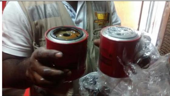
El equipo de micro filtrado captura todos los contaminantes existentes en el tanque de almacenamiento del combustible di6sel.
