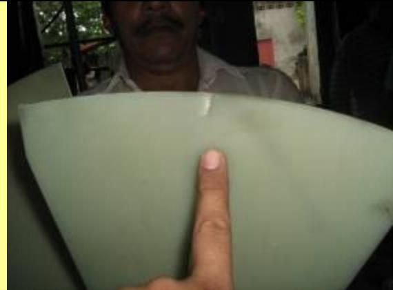
La hélices del ventilador llegan con una ranura, dejamos observación ya que no parece que sean involucradas con el balanceo dinámico del componente.
